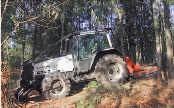
Tractor de neumáticos con desbrozadora de cadenas.
