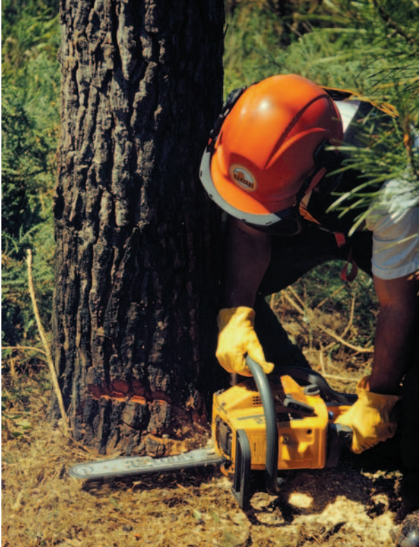
Una motosierra segura y bien afilada reduce las vibraciones.
