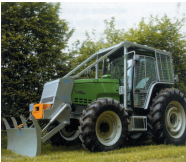
Tractor agrícola con cabina antivuelco y reforzada para trabajos forestales.
