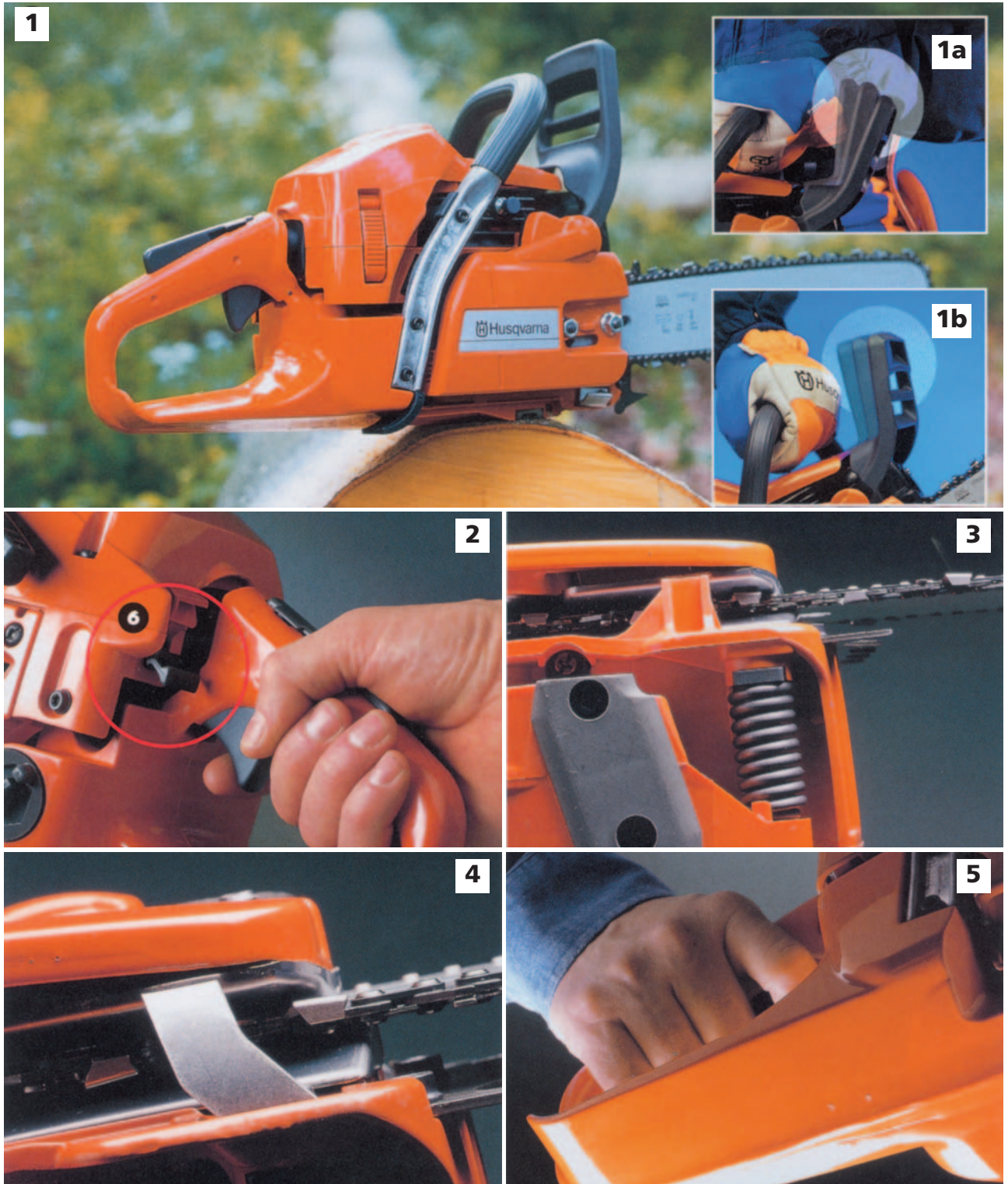
1. Protección contra rebote y freno de cadena. 2. Retén contra aceleraciones involuntarias. 3. Eficaz amortiguación de vibraciones. 4. Captor de cadena. 5. Protección de mano derecha.
