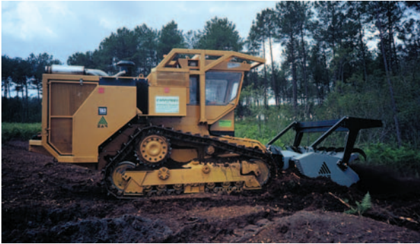
Tractor de cadenas con trituradora de martillos, perfectamente protegido.
